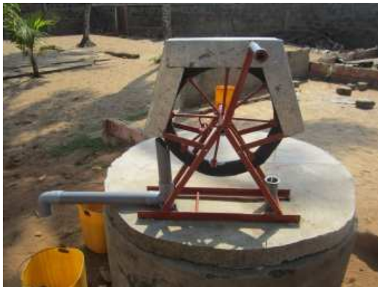
waterput met touwpomp
